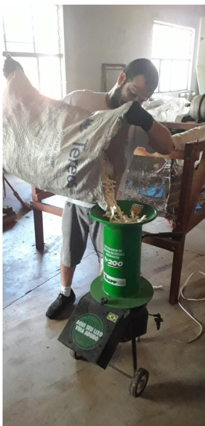
Fotos 4 e 5. Processo de trituração dos resíduos orgânicos.
