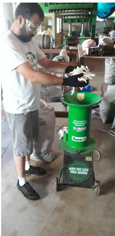
Fotos 4 e 5. Processo de trituração dos resíduos orgânicos.
